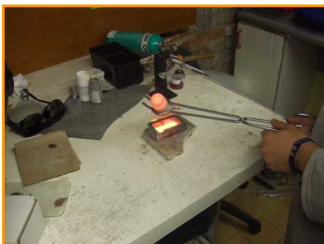
Pouring the bar
